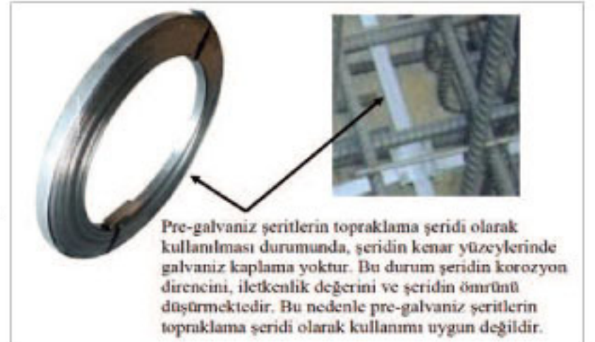
Şekil 4. Pre-galvaniz şeridin topraklama şeridi olarak kullanılması durumunda görülen sakıncalar.
