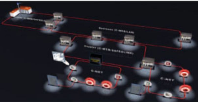
Şekil 3: Standart alarm durumunda yangın koruma sistemi şeması
