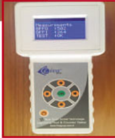
Test Edilen Paratonerin, test cihazı ekranındaki test sonuçları
