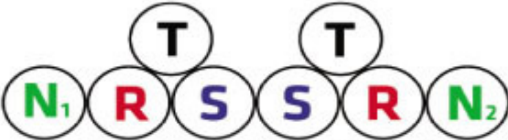
Resim 7: Düz zemin üzerinde 9 tek damarlı kablo ile beslenen sistemler
